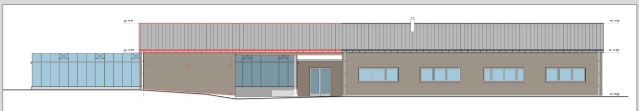
Abbildung 14: geplante Erweiterung des bestehenden Schuppens im Süden mit Überdachung (rechts im roten Bereich) und Umkleideraum (links im roten Bereich). Quelle: Romain Hoffmann Architectes et Urbanistes s.à r.l. 2019
