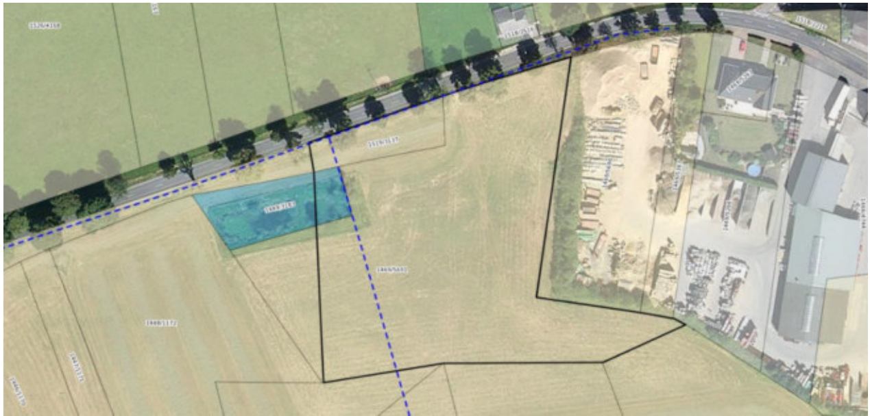
Abbildung 14: Abgrenzung des Plangebietes der PAG-Änderung (schwarz) und Verlauf eines Kanals zur Entwässerung (blau) von der N22 in Richtung Attert. Quelle: http://www.geoportail.lu
